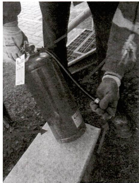
**Paso N° 5.-** Verificar el estado del precinto de seguridad, *pestillo de seguridad* manguera de descarga, tobera, manija de descarga, manija de transporte y estado total del cilindro.
